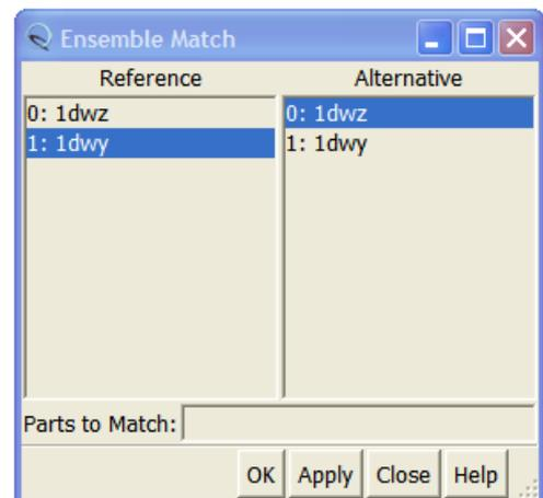
Tragen Sie den Atom-Spezifizierungsausdruck **@n@ca@c** hier ein, um nur die Atome des Rückgrats zu berücksichtigen. Es ist außerdem möglich, nur bestimmte Restgruppen für die Überlagerung zu berücksichtigen. Der Atom-Spezifizierungsausdruck **: 124-227.a@n@ca@c** bedeutet beispielsweise, dass für die Berechnung nur Atome des Rückgrats verwendet werden und auch nur von den Restgruppen 124 bis 227.
